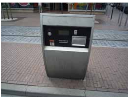
資料4 - 8・9 正午からは許可カードを挿入するか、管理者にモニターを通じ連絡し、車止めを下げてもらう。
